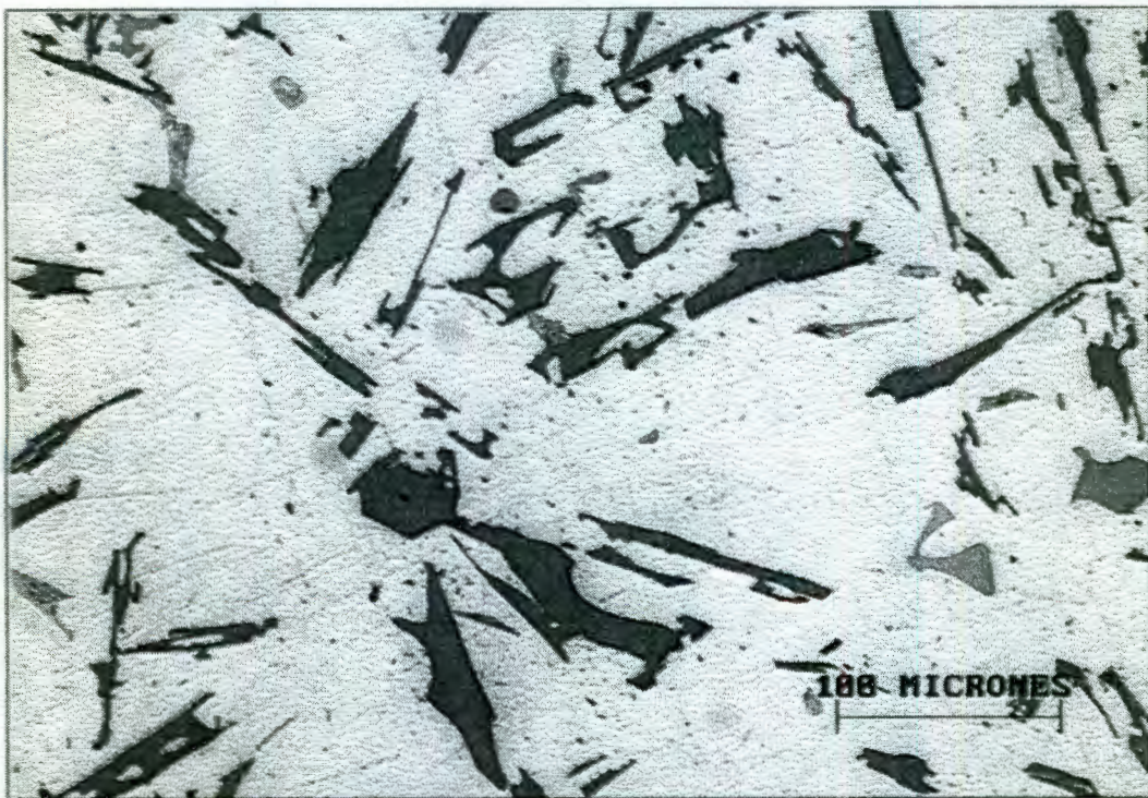
Fig. III.16. Microestructura de una muestra a una distancia de 17.5 cm a partir de la placa de enfriamiento. Ataque 0.5% HF observada a 200X.
