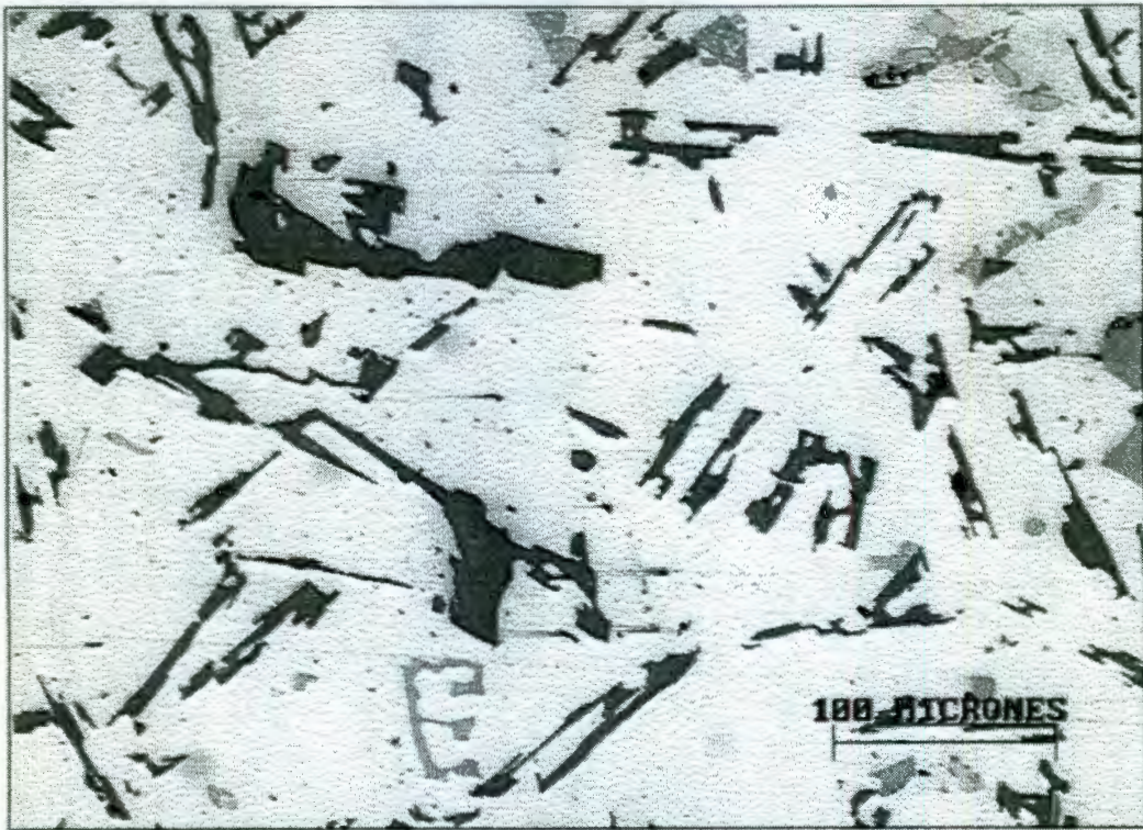
Fig. III.15. Microestructura de una muestra a una distancia de 15 cm a partir de la placa de enfriamiento. Ataque 0.5% HF observada a 200X.
