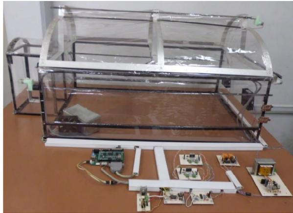
**Figura 4.8. Prototipo de invernadero.**
