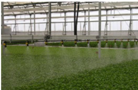
**Figura 2.8. Sistema de riego aéreo (tren de riego).**
