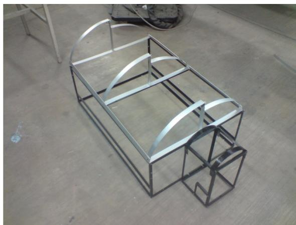
**Figura 3.11 Construcción de la estructura del invernadero.**
