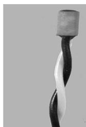
**Figura 3.13.Sensor de temperatura.**
