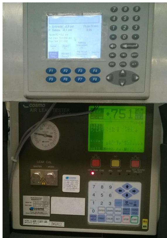
Figura 16. Cosmo de prueba de fugas de aire en B07.
