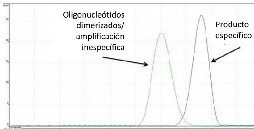
**Figura 2.7. Análisis de la curva de fusión (obsérvese la diferencia entre un pico elevado a partir del control negativo que indica la formación de primer-dimers; mientras que el segundo indica la disociación del amplicón de la PCR (Costa, 2005).**
