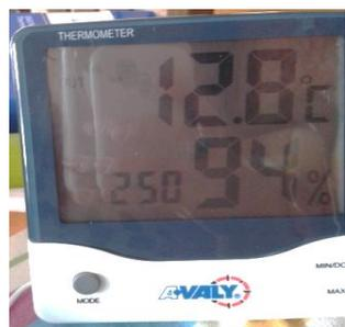
Figura 12 Termo-higrómetro
