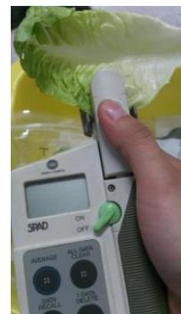
**Figura 13** Medidor de Clorofila SPAD-502Plus
