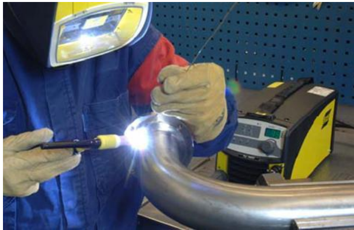
Ilustración 49 Soldadura de tubo doblado
