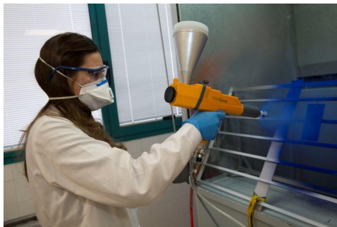
Ilustración 50 Aplicaciones de pintura anticorrosiva
