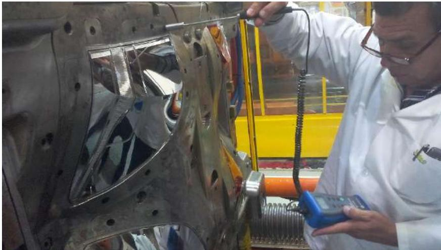
Fig. 18.- Verificación de la temperatura del molde (lado fijo y lado móvil)
