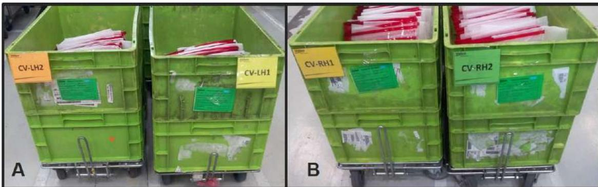
**Fig. 30.- Identificación de los contenedores por lado y cavidad.**
