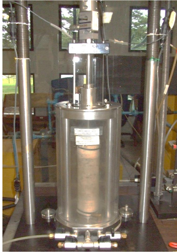
Figura 2.18 Ensamble final de la probeta en el equipo triaxial cíclico
