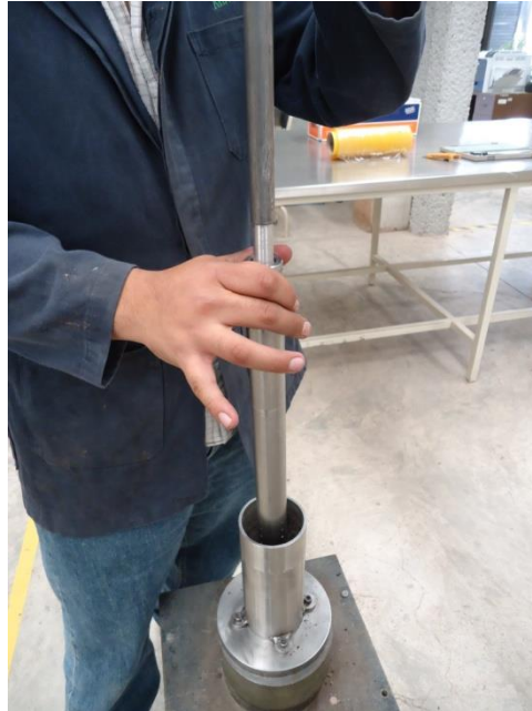
Figura 2.8 Compactación del espécimen de suelo
