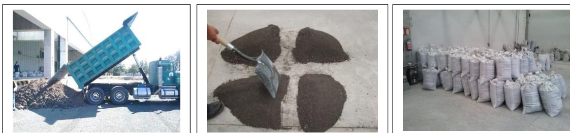
Figura 2.1 Muestreo, cuarteo y almacenaje de muestras
