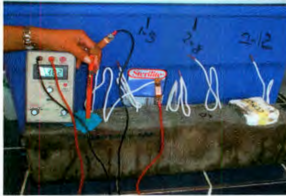
Figura 10. Realización de pruebas electroquímicas.
