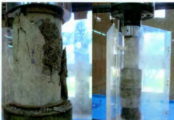
Figura 14. Ensayo de resistencia a la compresión.
