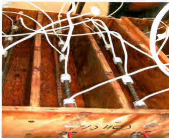
Figura 9. Diseño de los moldes para las probetas
