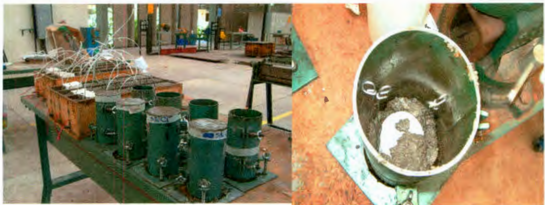
Figura 7. Probetas durante el proceso de colado.
