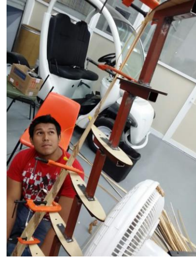
Figura 3.11 y 3.12 Construcción del aspa del aerogenerador
