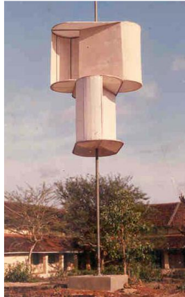
Figura 2.7 Aerogenerador de bajo costo tipo Savonius con aspas desfasadas 90^\circ
