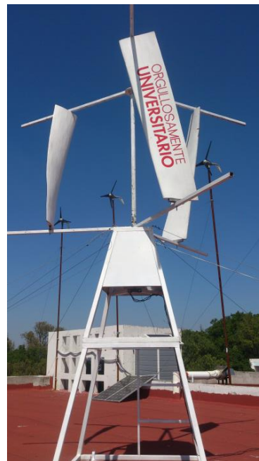
Figura 4.1 y 4.2 Modelos de aerogeneradores de eje vertical de 1 KWatt construidos en la Universidad Autónoma de Querétaro
