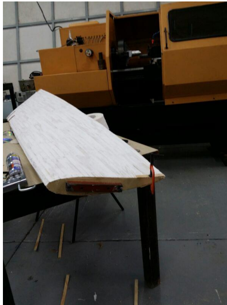
Figura 3.13 Recubrimiento del aspa por resanador industrial para evitar filtraciones
