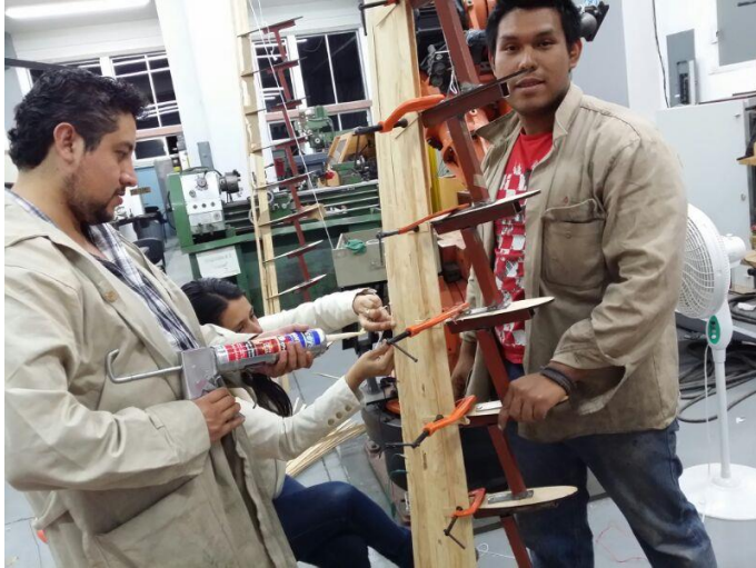
Figura 3.11 y 3.12 Construcción del aspa del aerogenerador
