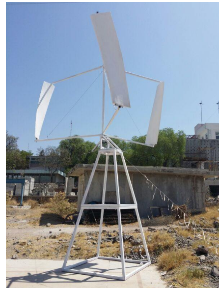
Figura 3.17 y 3.18 Montaje del modelo del aerogenerador para pruebas de estabilidad
