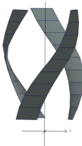
Figura 3.11 Modelo de aspas en 3D con aerodinámica de NACA 3615
