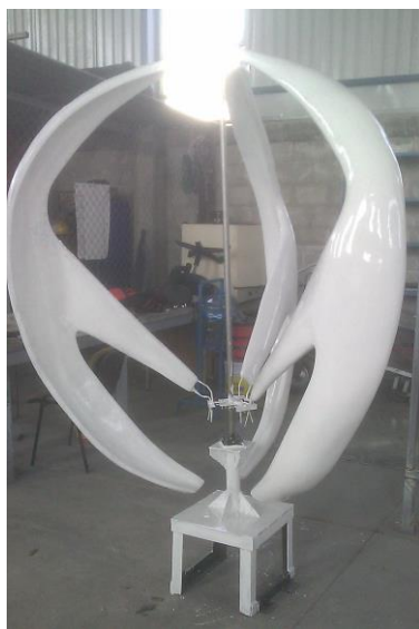
Figura 4.1 y 4.2 Modelos de aerogeneradores de eje vertical de 1 KWatt construidos en la Universidad Autónoma de Querétaro
