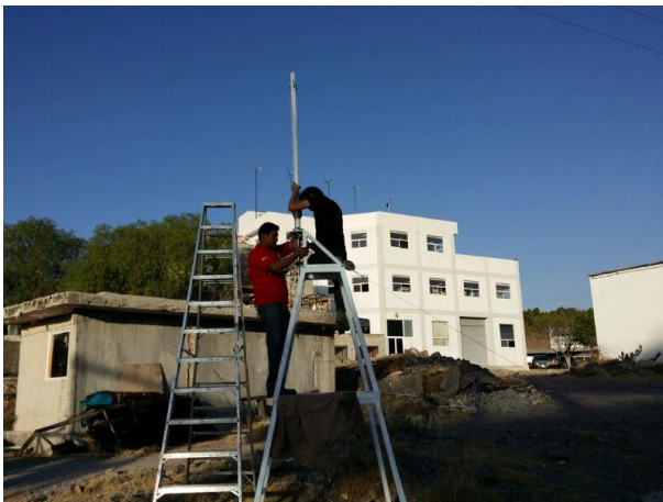
Figura 3.17 y 3.18 Montaje del modelo del aerogenerador para pruebas de estabilidad
