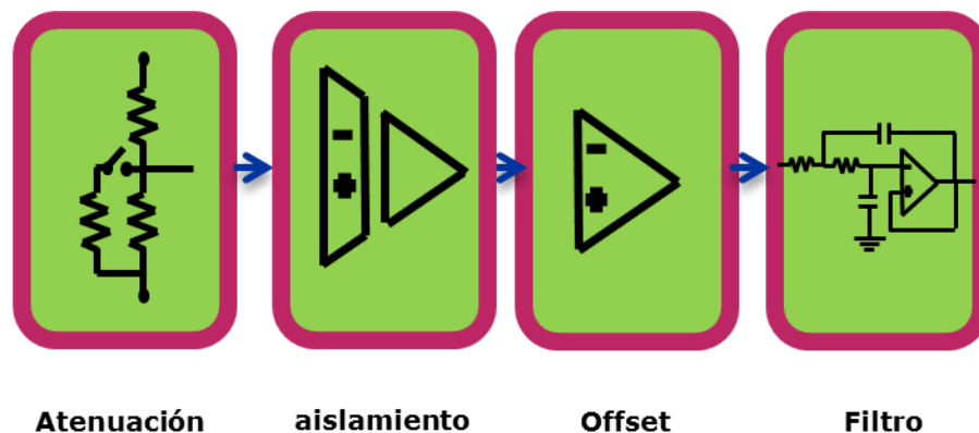
Figura III.1. Diagrama de bloques de acondicionamiento para señal de voltaje.
