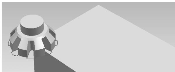
Figura C.1. Operación de fresado de refrentar.
