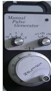
Figura 2.20. Generador de pulso manual (volante).
