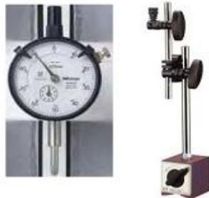
Figura 1.9. Indicador y palpador de pestaña con base.
