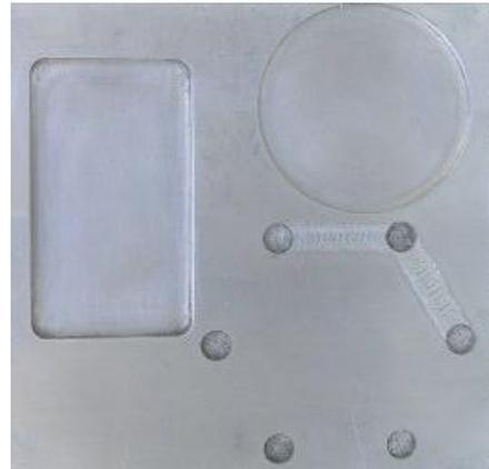
Figura 5.12. Maquinado de rectángulo, círculo y polígono de barrenos.
