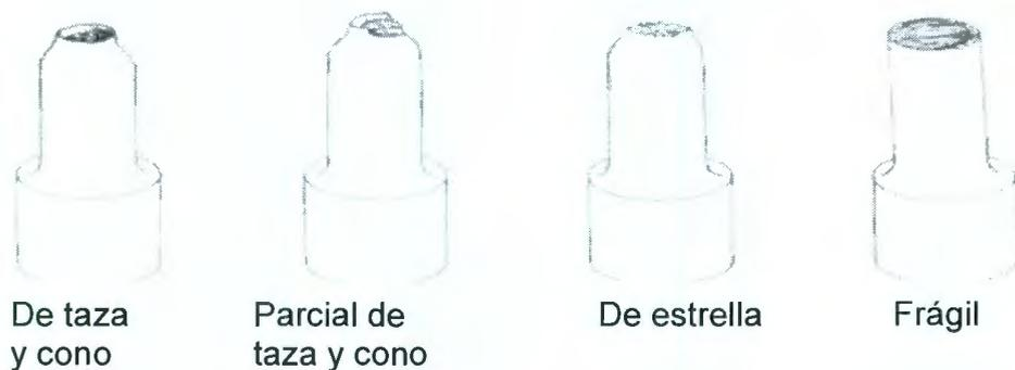
Figura 9. Aspecto de la fractura, (González, V. J. L. 1998. Mecánica de Fractura, Bases y aplicaciones. 1°. Ed., Editorial Limusa, México).
