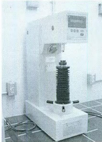
Figura 18. Durómetro duplex modelo 713 SRD, (Foto, tomada por el autor en el laboratorio del Instituto Mexicano del Transporte, IMT).
