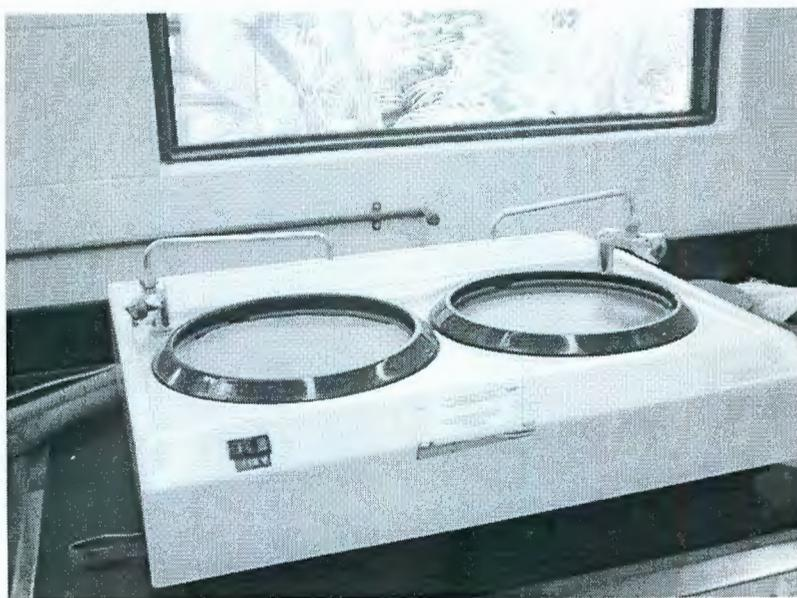
Figura 22. Lijadora. Modelo Dup Serie 9.03849, (Foto, tomada por el autor).
