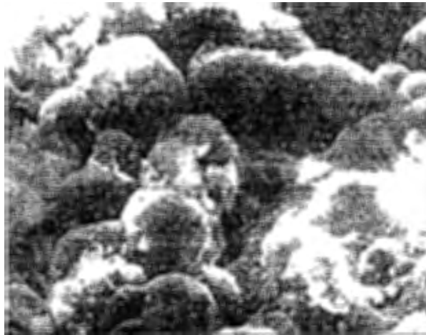
Figura II.24. Ordenamiento espacial tipo oolítica o nodular. Arcillas volcánicas de La Laguna, Tenerife. (González de Vallejo, 2004).
