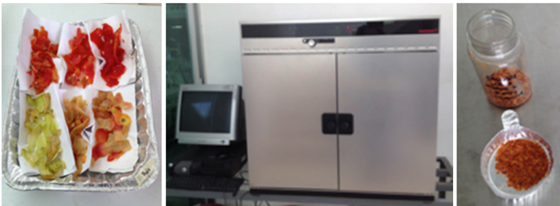
Figura 4-19. Material vegetal en los 6 estadios de maduración (Izquierda), estufa de secado de convección forzada con la cual se realizó la operación de secado (Centro) y Material vegetal seleccionado y procesado para las pruebas de extracción de carotenoides (Derecha).
