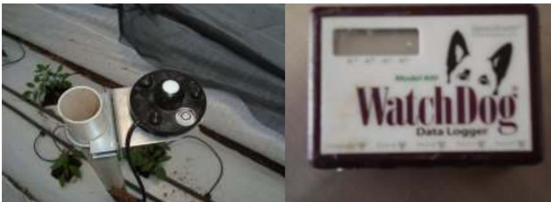
**Figura 3. 15 Sensor y Datalogger de radiación solar**
