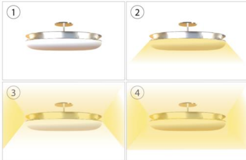
Figura 45. Distribución del flujo luminoso de la luminaria.
