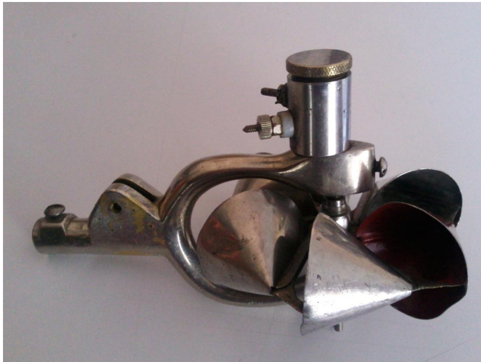
Figura 3.13 Molinete hidrométrico tipo taza cónica utilizado para el desarrollo del trabajo.
