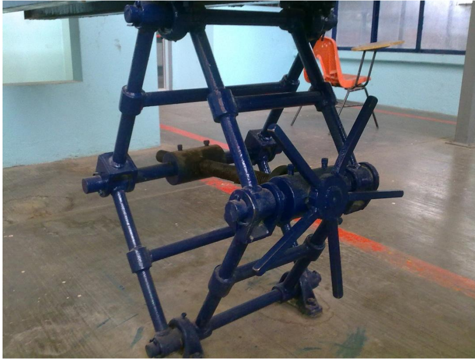
Figura 3.3 Brazo que permite la inclinación del canal de pruebas
