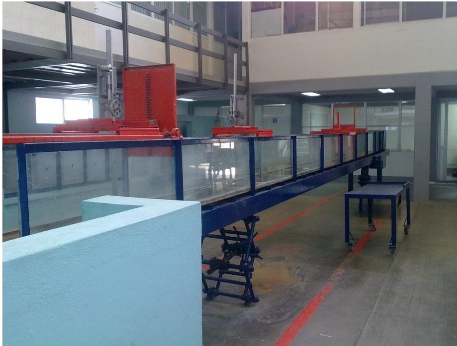
Figura 3.2 Canal de Pruebas hidrométricas, Lab. De hidráulica, Facultad de Ingeniería UAQ.
