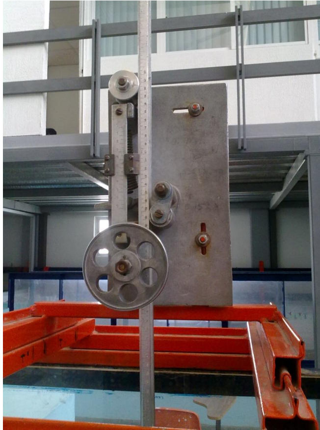
Figura 3.5 Instrumentos utilizados para medir la altura del flujo, localizados detrás de las compuertas.
