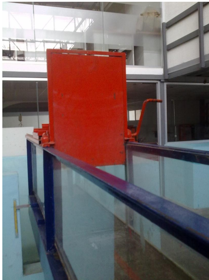
Figura 3.4 Compuertas obstructoras de caudal localizadas en el canal de pruebas.
