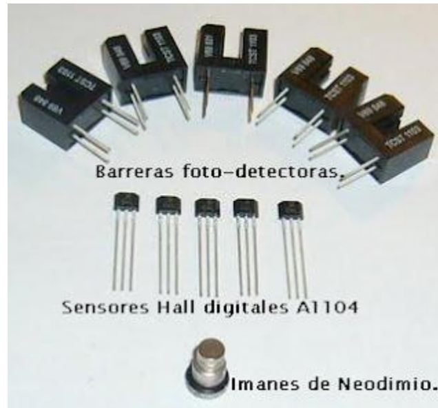
Figura 2.3 Transductores comunes para la fabricación de encoders ópticos y magnéticos.
