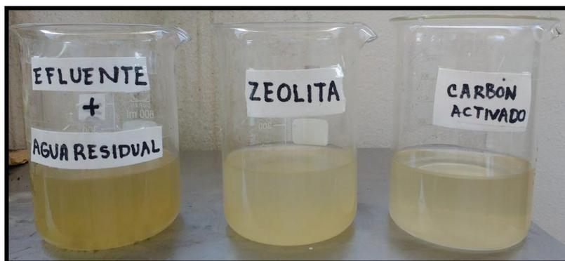
**Figura 22.** Filtrados resultantes al pasar el efluente + agua residual, a través de filtros de carbón activado granular y zeolita.
