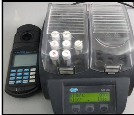
**Figura 15.** Ensayos para medición de DQO de los filtrados con carbón activado y zeolita en el colorímetro HACH DR/890.
