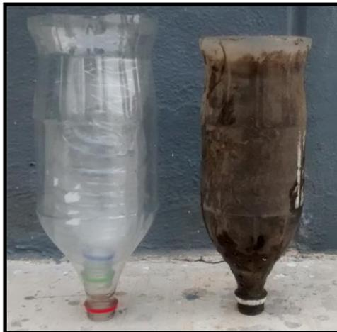
**Figura 23.** Adherencia de la biopelícula en un sistema anaerobio después de 6 meses
