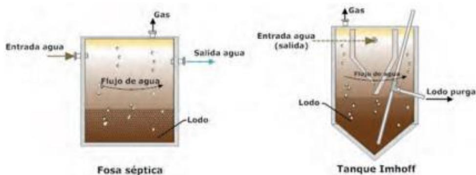
**Figura 1.** Procesos anaerobios primera generación (Fosa séptica y Tanque Imhoff).
