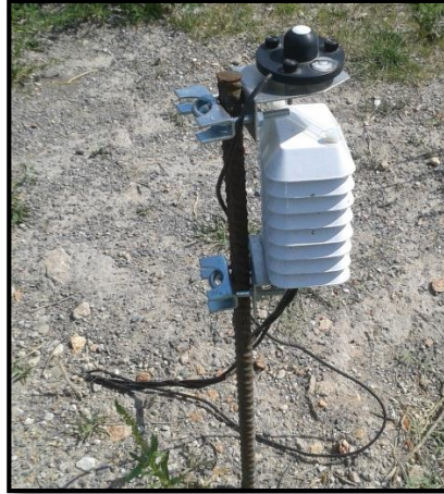
Figura 9 Sensor de radiación y temperatura con protector de radiación.
