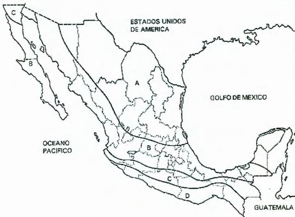
**fig. 15** Regionalización sísmica de México (Manual de Diseño de Obras Civiles, CFE).
