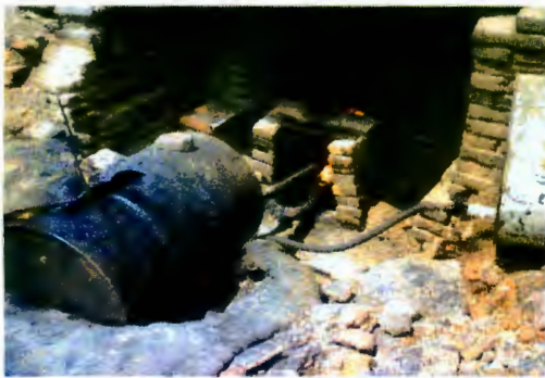
B) Quemador (centro) y suministro de combustible (depósito de la izquierda) y agua (depósito de la derecha)
