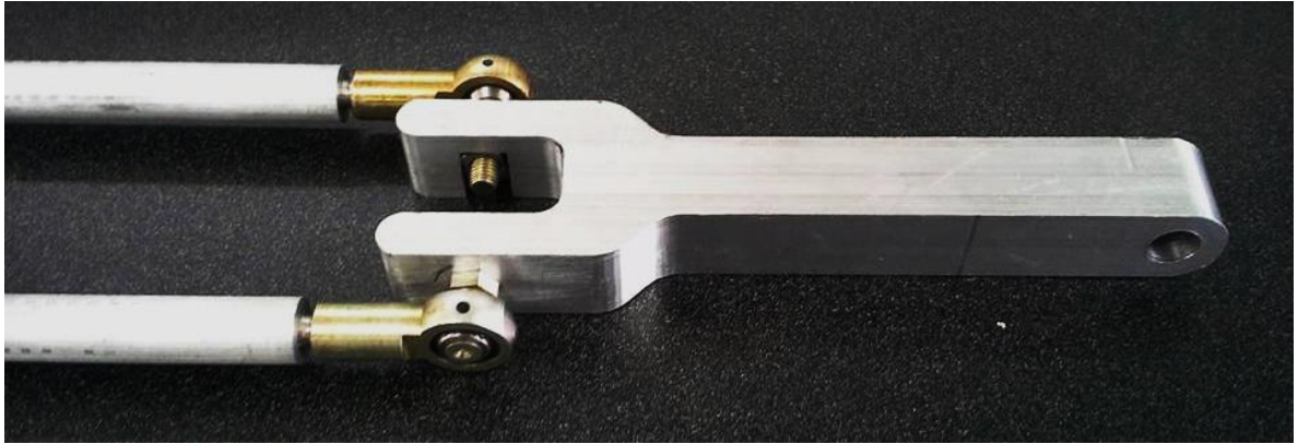
Figura 45: Ensamble Antebrazos y Brazos Principales.
