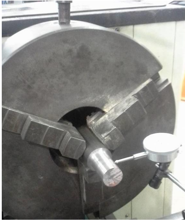
Figura 18: Ajuste final con Indicador de Carátula (3 Mordazas)
