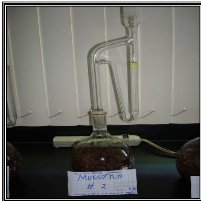
Figura 5.2 Obtención del aceite de orégano por el método de hidrodestilación
