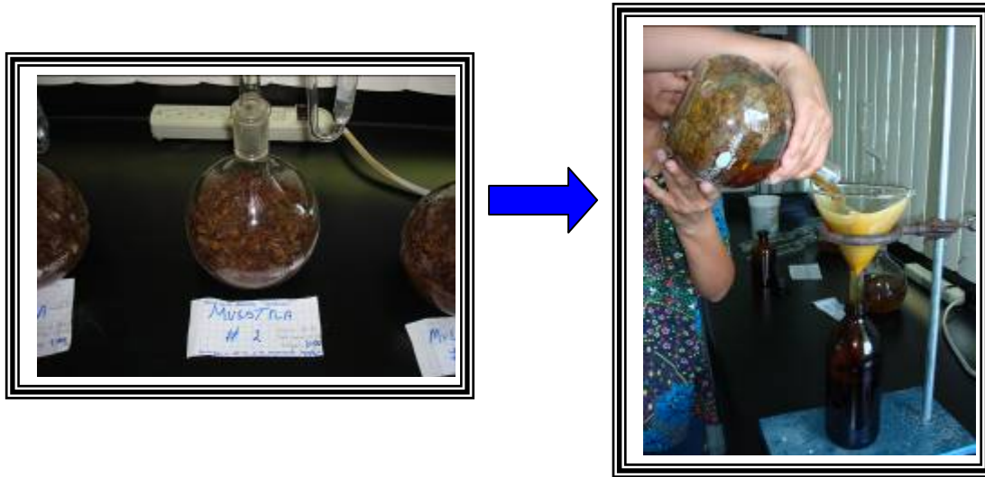
Figura 4.5 Separación de las aguas madre de orégano del proceso de hidrodestilación.
