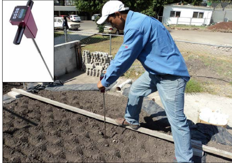
Figura 4.7. Medición de resistencia a la penetración.
