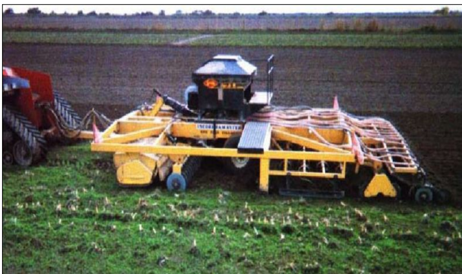
Figura 2.7. Implemento de labranza de un solo paso (Shrinivasa et al. , 2001).
