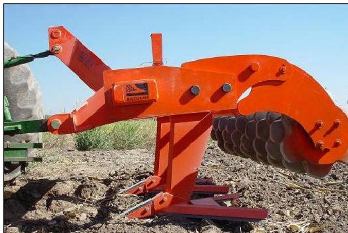
Figura 2.9. Combinación de Multiarado Subsolador y rueda Aqueel™ para la preparación del suelo (Ventura et al. , 2003)
