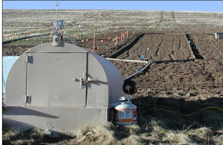
Figura 2.16. Parcela de escurrimiento tipo USLE, en la Estación Experimental de USDA-ARS (Agricultural Research Service) de Palouse, Estado de Washington, Estados Unidos.
