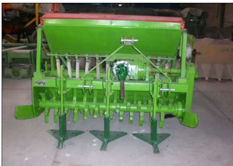
Figura 2.8. Máquina combinada de labranza reducida (Akbarnia et al , 2010)
