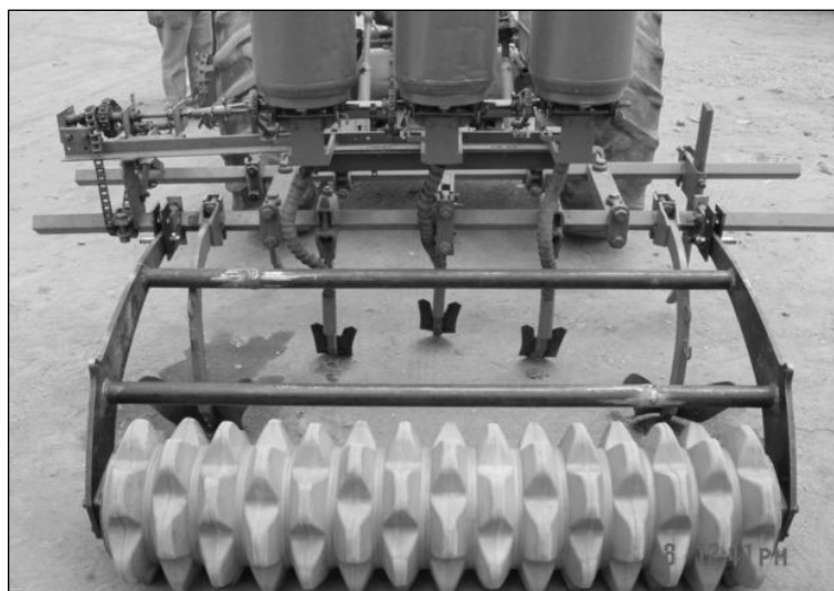
Figura 2.10. Combinación de Sembradora modificada con Rodillo Aqueel adaptado para la captación in situ del agua de lluvia (Ventura et al. , 2007)
