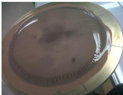
Imagen 14. Pasta extendida sobre la mesa de fluidez
