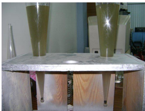
Imagen 7. Prueba de los conos Imhoff
