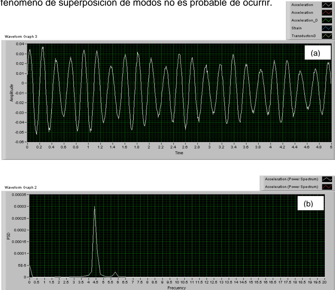
Figura 3.17 (a) Gráfica del modo de vibración del balanceo. (b) Frecuencia de balanceo.
