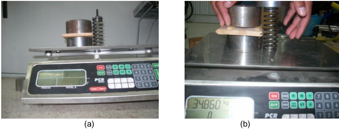
Figura 3.4 Práctica para la medición de la constante K del resorte. (a) Peso de referencia y resorte sin deformarse. (b) Peso necesario para deformar al resorte hasta una referencia de altura conocida.
