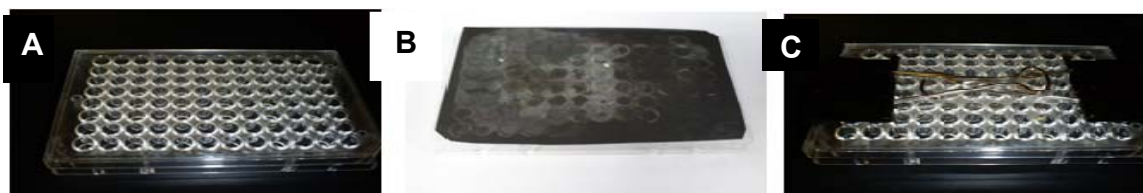
Figura 6.3 Procedimiento para detectar la capacidad de de las cepas de Trichoderma para volatilizar el Hg^{2+} . En (A) se muestra la placa en la cual inocularon las cepas y los tratamientos de HgCl_2 a la cual posteriormente se le colocó la placa de rayos X (B). El dispositivo se cerró colocando pinzas a presión (C) para que los vapores de Hg^{2+} no se pierdan y sean detectados por la placa.
