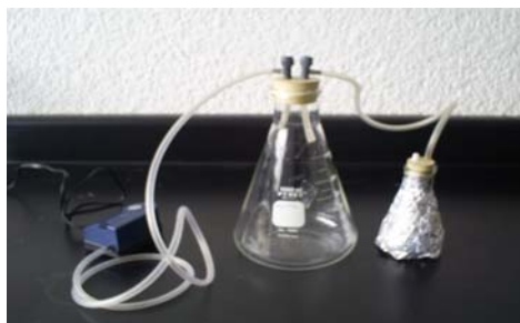
Figura 6.4 Sistema para determinar cuantitativamente \text{Hg}^0 volátil por Trichoderma spp. En el matraz de 1000 ml se crece el hongo, mientras que el matraz cubierto contiene \text{KMnO}_4 al 0.6% que funciona como trampa.
