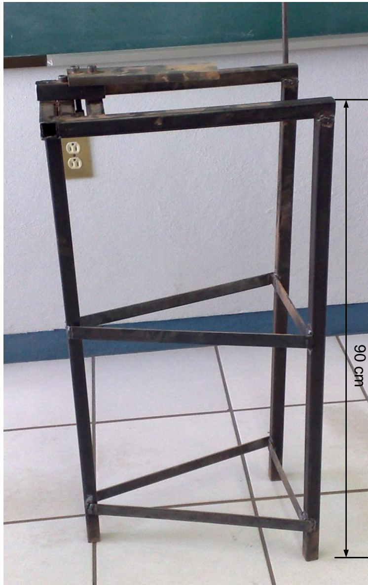
Fig. 6 Dispositivo de prueba portable para ensayos de fatiga al impacto de ladrillos de arilla recocida
