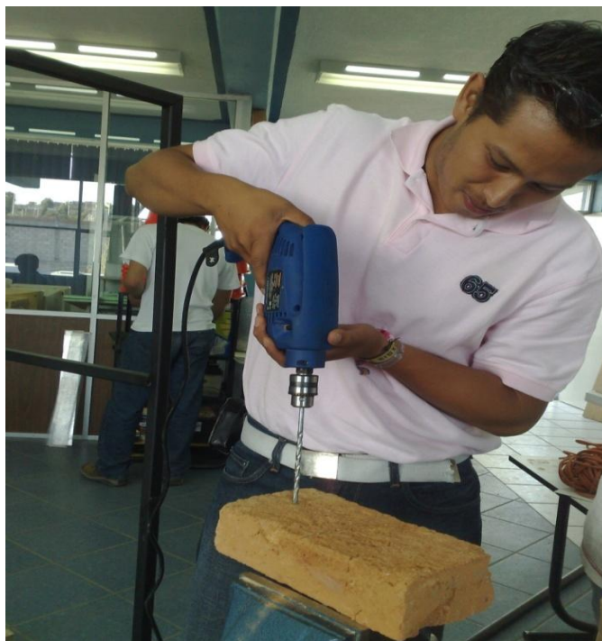
Fig. 7 Elaboración de los dos barrenos para cada espécimen.
