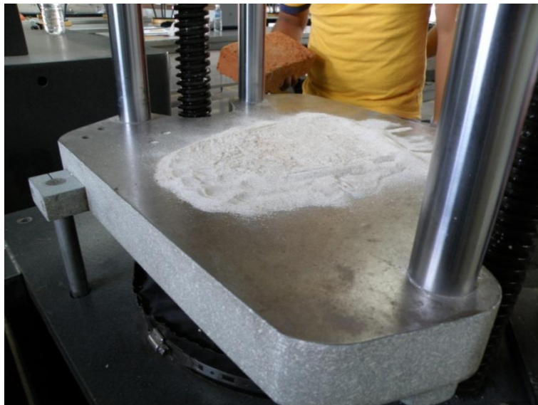
Fig. 24 Platina inferior de la máquina con una cama de arena sílica.
