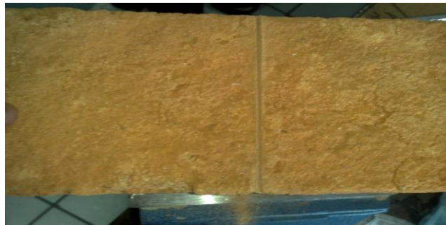
Fig. 8 Preparación de la muestra por cuanto a la elaboración de la muesca transversal.
