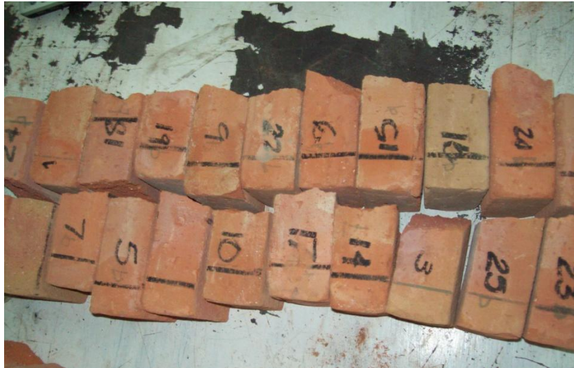
Fig.22 Mitades resultantes de la prueba de módulo de ruptura, a ser empleadas en la prueba a compresión.
