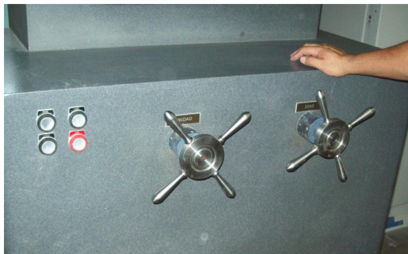
Fig. 21 Manivelas de las válvulas de carga y descarga de la máquina universal.
