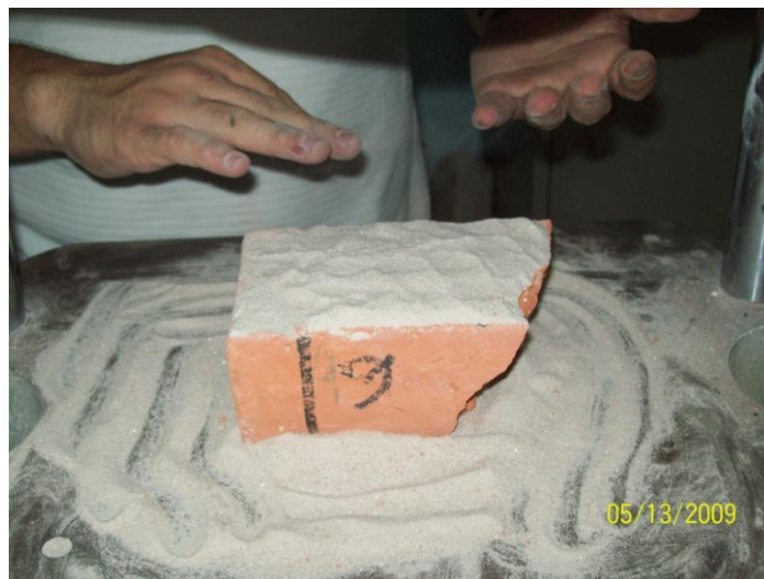
Fig. 26 Aplicación de cama de arena sílica en la parte superior del ladrillo.
