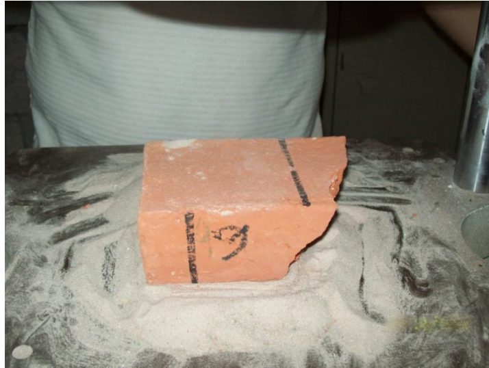
Fig. 25 Posicionamiento de la muestra en la cama inferior de arena sílica.
