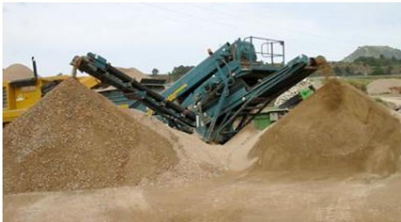
**Figura 5.30** Machacadora móvil de mandíbulas para la obtención de árido reciclado.
