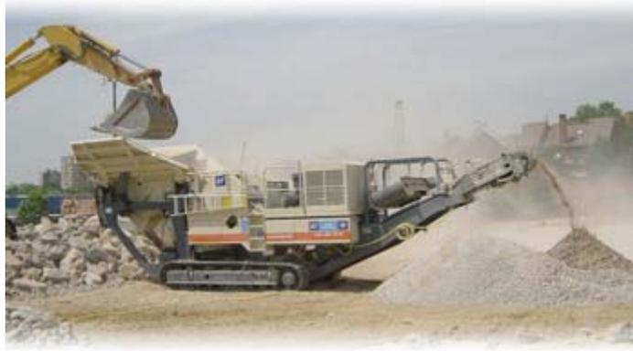
**Figura 5.24** *Planta de reciclado de áridos.*
