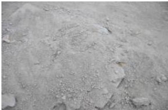
**Figura 4.28** MROC, producto del proceso de colado que incluyen restos de cemento.
