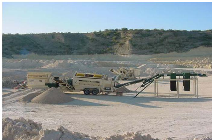
**Figura 5.29** Trómel móvil de clasificación; Cartón, elementos metálicos, finos, tierras y bloques para su machacado.
