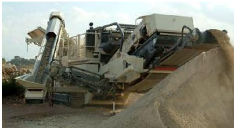
**Figura 5.31** Molino móvil triturador para la obtención de áridos reciclado.
