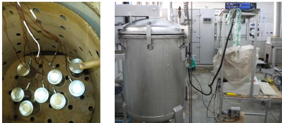
Figura 3. Acomodo de las latas con los termopares dentro de la autoclave conectados a un sistema de adquisición de datos.
