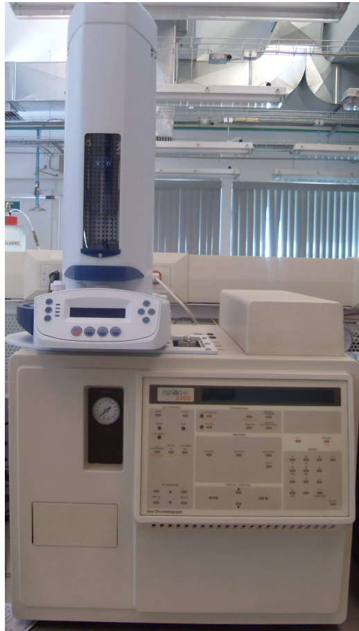
Figura 5. Foto del cromatógrafo Varian 3300, equipado con un detector de ionización de flama FID
