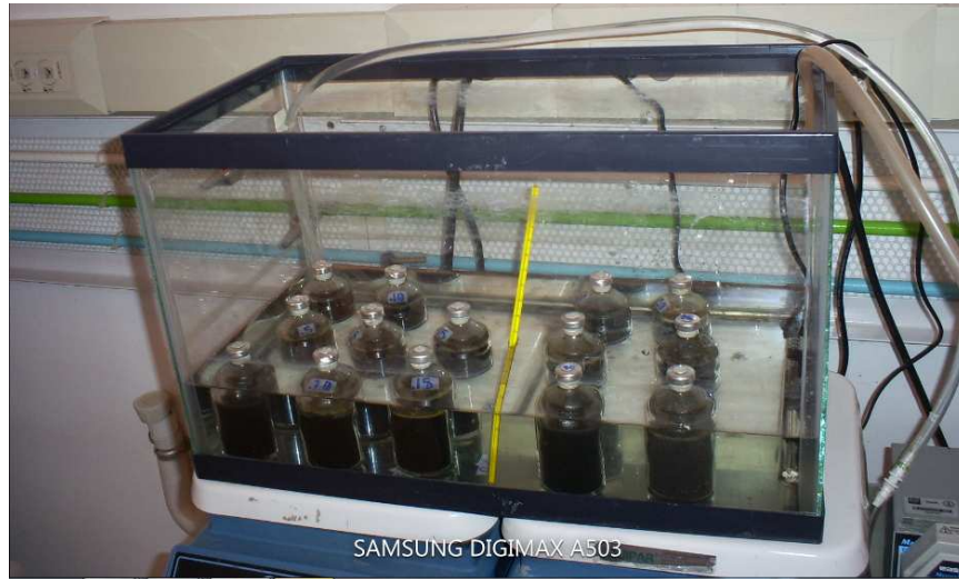
Figura 2. Arreglo experimental donde se acomodan los reactores de tal forma que todos y cada uno estén sobre un agitador para mantener la mezcla homogénea, cada reactor se encuentra sellado a fin de evitar la fuga del biogás. La temperatura se mide con el termómetro para evitar cambios drásticos.
