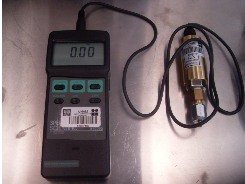
Figura 3. Foto del transductor de presión, este aparato puede medir presiones en las diferentes unidades: atm, mmHg, Pa, psi.
