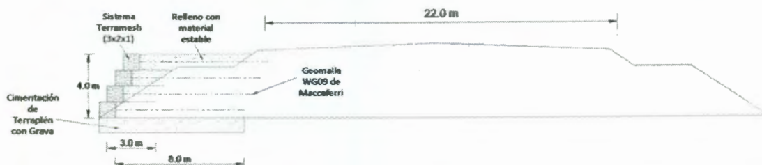
Figura 5.1: Proyecto de estabilización de talud usando el sistema Terramesh de Maccaferri en el entronque a Nánchital, Ver.
