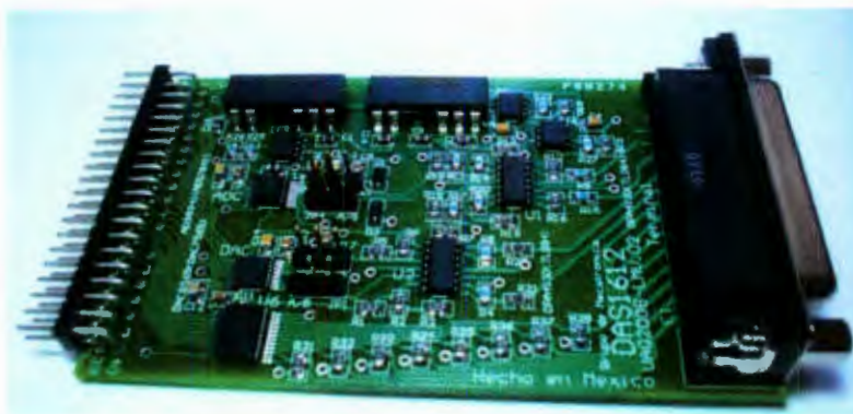
Figura 3.12 Sistema de adquisición de datos DAS1612.
