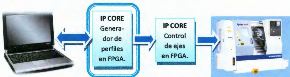
Figura 1.1 Diagrama a bloques general del sistema de maquinaria CNC.
