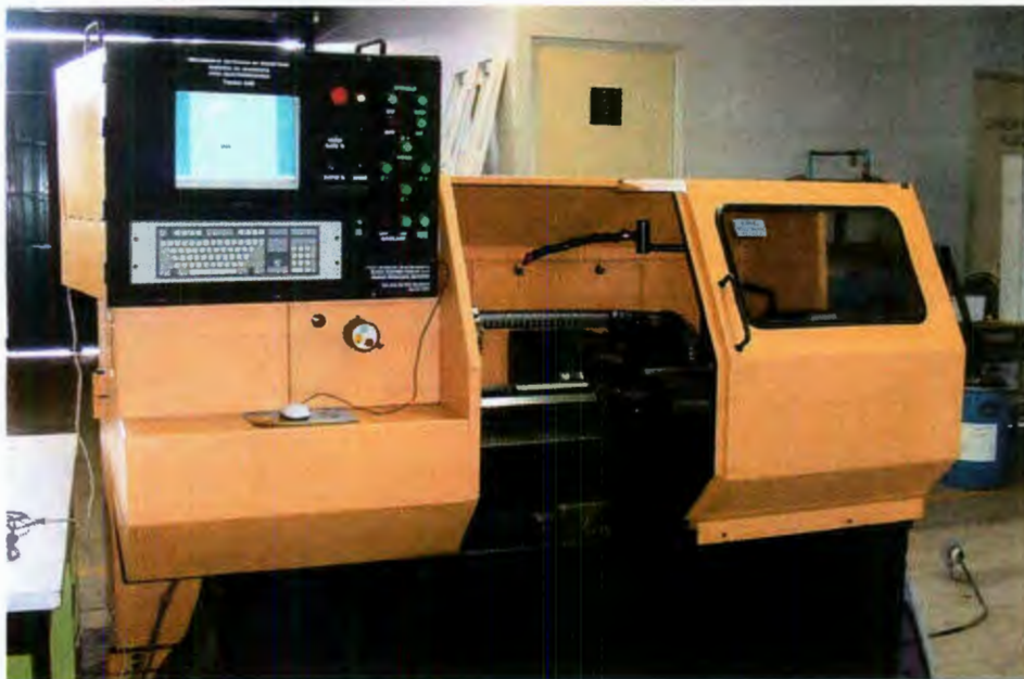
Figura 3.10 Torno CNC reconvertido.
