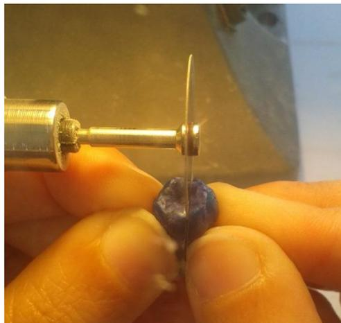
Figura 22. Corte longitudinal mesio-distal con disco diamantado
