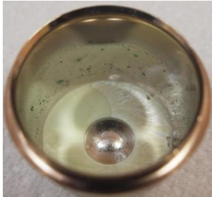
**Figura 6.13** Crisol de platino – oro con 5 g de polietileno y fundente (MTBL), después de un proceso de calcinación a 950°C.
