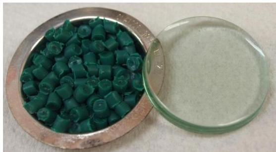
**Figura 2.8** Pellets de polietileno ERM EC-681k y un disco del mismo material calcinado y fundido.
