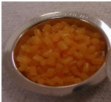
**Figura 2.3** Polipropileno usado en la prueba CCQM para análisis de Cd, Cr, Hg y Pb.
