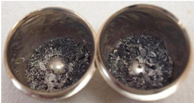
**Figura 5.5** Polietileno calcinado mezclado con fundente (EC 681k).
