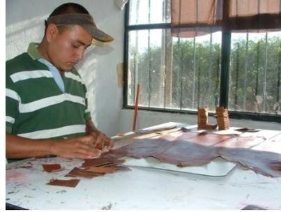
3.- Rebajado de las piezas: en esta etapa se realiza un rebajado de los bordes y de sus interiores para facilitar el doblado, empleando una maquina llamada “rebajadora”.
