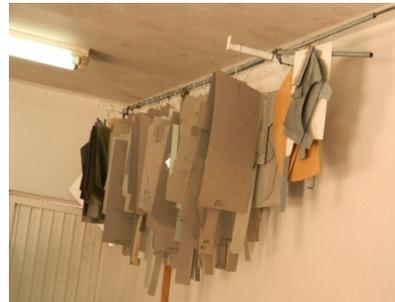
3.- Corte de las piezas que integran la cartera: la piel es cortada con el apoyo de los moldes y empleado chuchillas o cúters (fabricados por los propios trabajadores), el corte de la piezas puede realizarse sobre piel natural o sintética; en esta misma etapa se realizan cortes del cartón o del plástico que son empleados para dar rigidez y forma al interior de la billetera.
