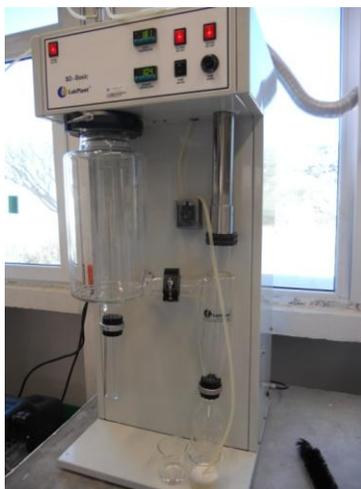
Figura 14. Secador por aspersión utilizado para la obtención de las microcápsulas.
