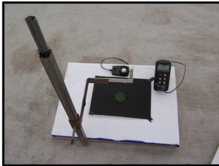
Figura 3.3.2.1.1. Estructura usada en la toma de imágenes en hojas de chile y jitomate para evaluar el efecto de tres alturas diferentes.
