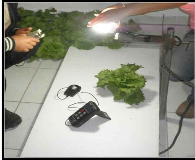
Figura 3.3.3.c. Mediciones en cuarto oscuro con una lámpara fluorescente de 100 watts.
