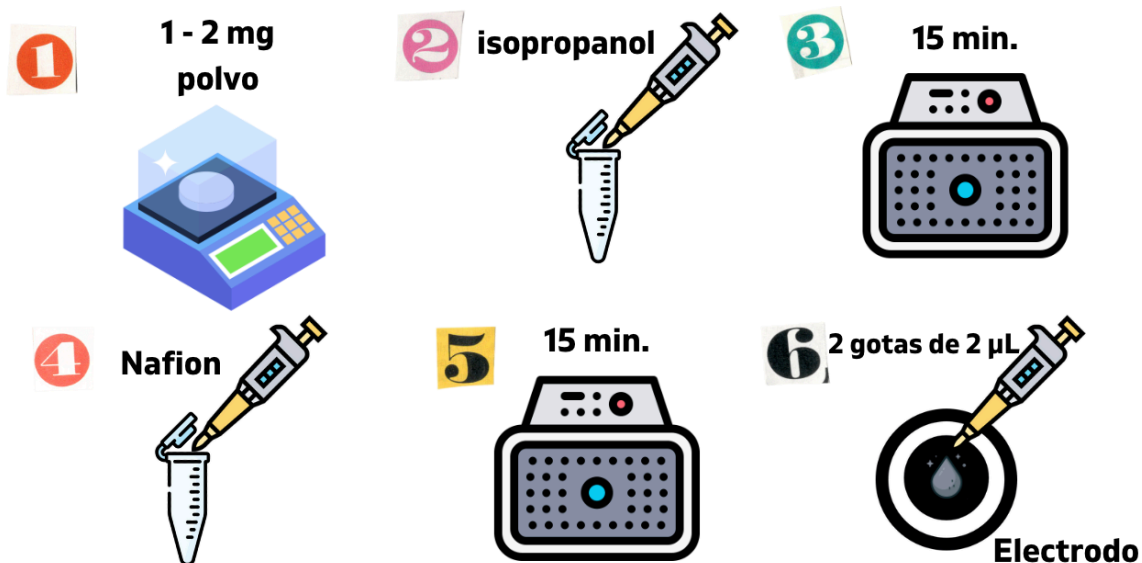
Ilustración 26. Descripción gráfica de la preparación de tintas sobre el electrodo de trabajo.
