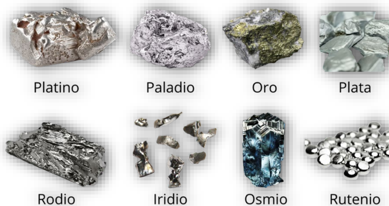
Ilustración 8. Metales preciosos utilizados para electrodos.
