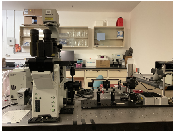
Figura 12: Sistema de pinzas ópticas: Láser, espejos galvanométricos y juego de lentes unidos al microscopio Olympus IX y la cámara Andor Luca R para la visualización digital.
