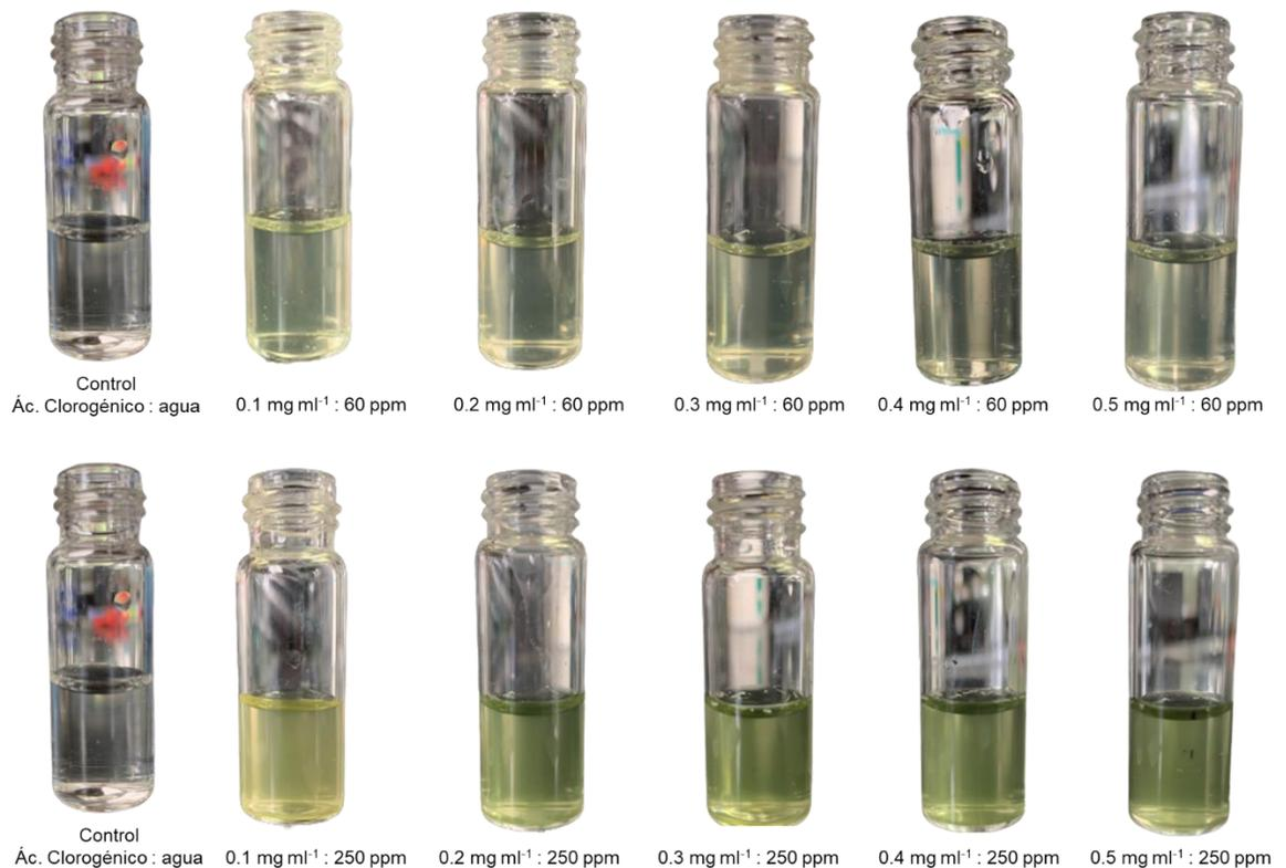
Figura 46: Reacción *in vitro* de ácido clorogénico ( $0.1-0.5 \text{ mg ml}^{-1}$ ) y  $\text{Fe}_2(\text{SO}_4)_3$  (60 y 250 ppm).
