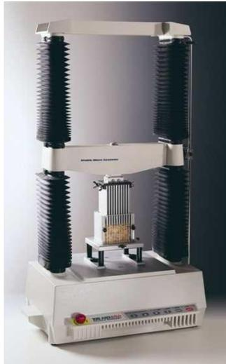
**Figura 8.** Texturómetro (TA-XT2i, TA-XT Plus, Inglaterra)
