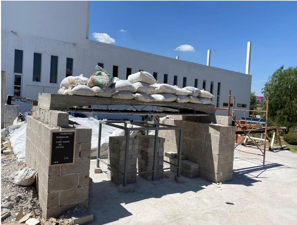
Figura 5.6 Modelo experimental de la prueba "Deformación y carga máxima del sistema (carga de servicio mínima)". Sistema LMA sometido a carga uniformemente distribuida  $W_s=350 \text{ kg/m}^2$
