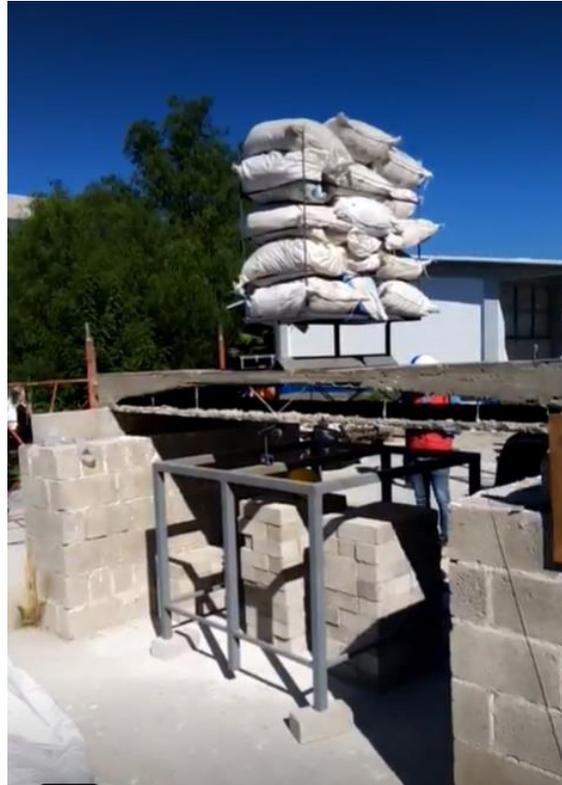
Figura 5.1 Modelo experimental de la prueba "Resistencia del componente estructural". Modelo LMA sometido a carga  $P=675$  kg al centro del claro.
