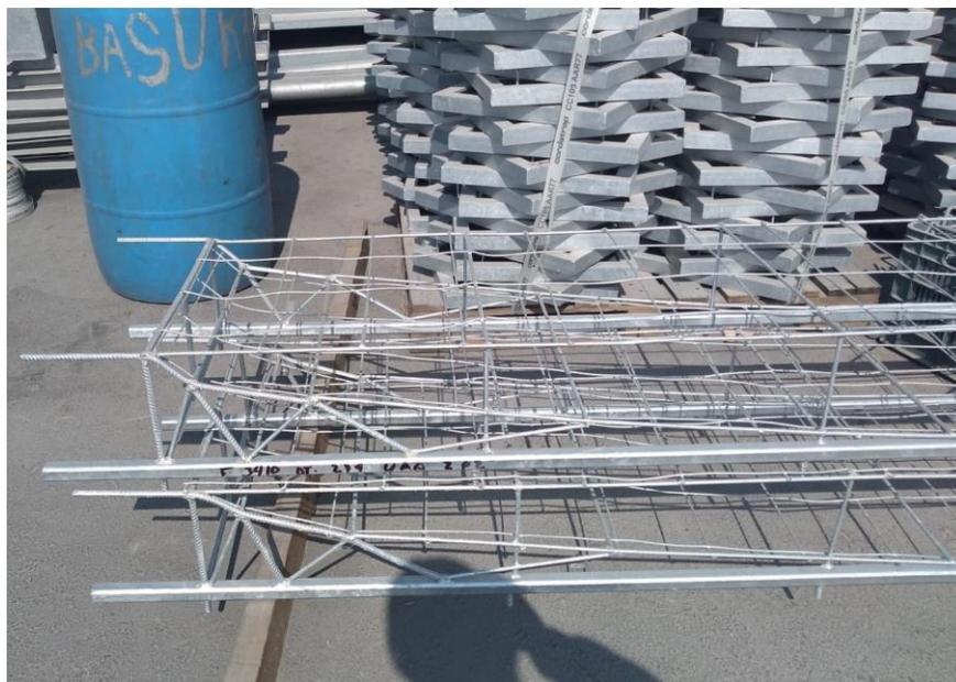
*Figura 2.4 Módulos LMA galvanizados*
