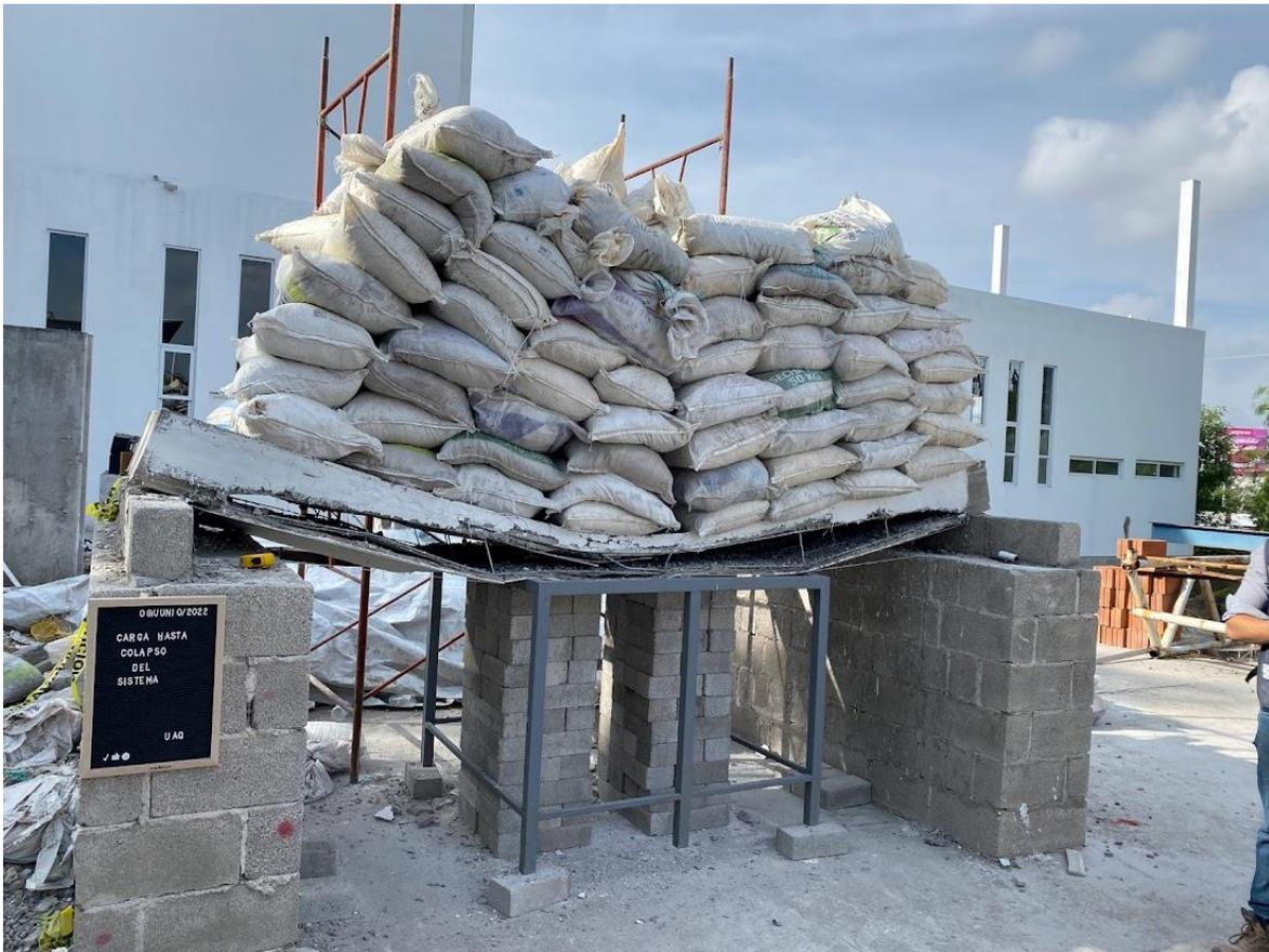
*Figura 5.15 Colapso del sistema. Sistema LMA sometido a carga uniformemente distribuida  $W_s=1489 \text{ kg/m}^2$*
