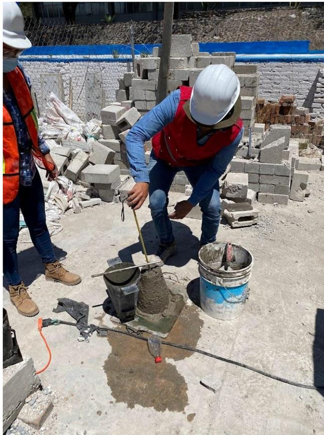
*Figura 2.11 prueba de revenimiento en proceso de colado de concreto*
