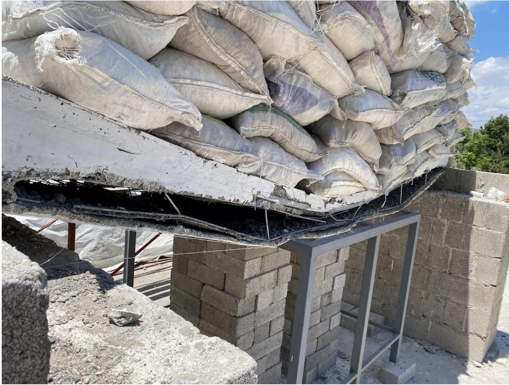
*Figura 5.20 Perspectiva de elementos que fallaron al colapso del sistema*
