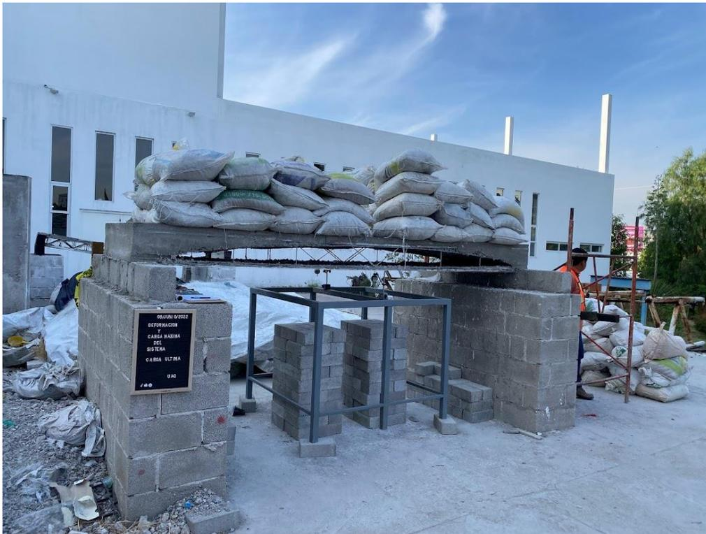
Figura 5.10 Modelo experimental prueba "Deformación y carga máxima del sistema (carga última)" Sistema LMA sometido a carga uniformemente distribuida  $W_s=584 \text{ kg/m}^2$
