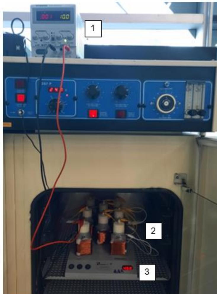
Figura 6 Sistema de fermentación electrostática en incubadora. 1) Fuente de poder, 2) Biorreactores, 3) Placa de agitación (Elaboración propia)
