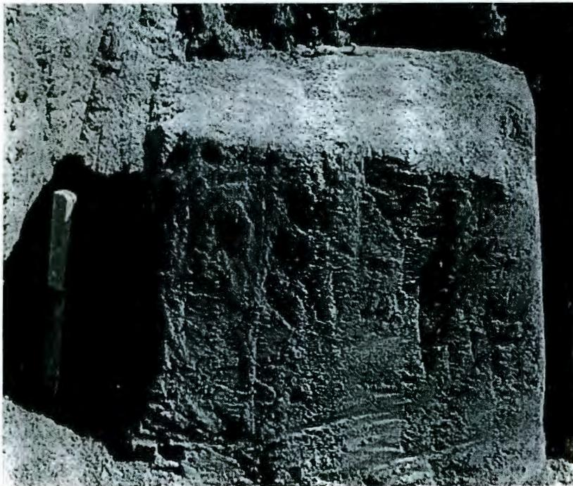
Figura 3.3.- Detalle del labrado de una muestra inalterada.
