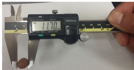
Figura 3-20 Medición del grosor de la croqueta
