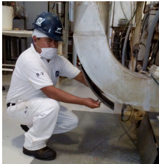
Figura 3-36 Toma de muestra a salida de extrusor
