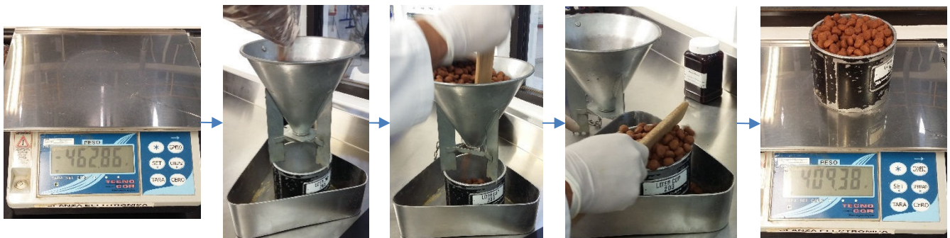
Figura 3-17 Determinación de peso específico en extruidos
