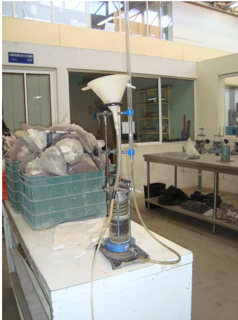
Figura 4.4 Permeámetro de carga variable
