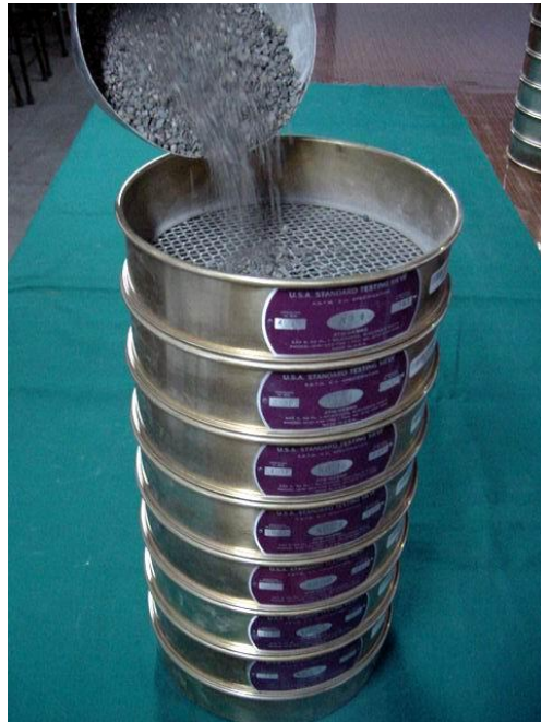
Figura 3.3 Análisis granulométrico por mallado
