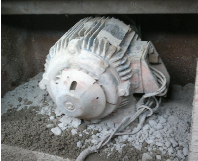
Figura 4.14 Motor para someter a vibrocompactación los tabicones de tepetate-cal-ceniza volante
