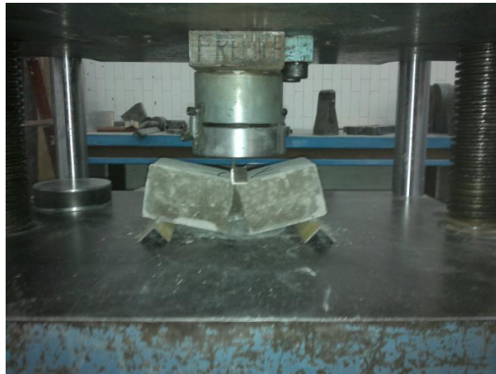
Figura 3.23 Prueba para determinar el modulo de ruptura.
