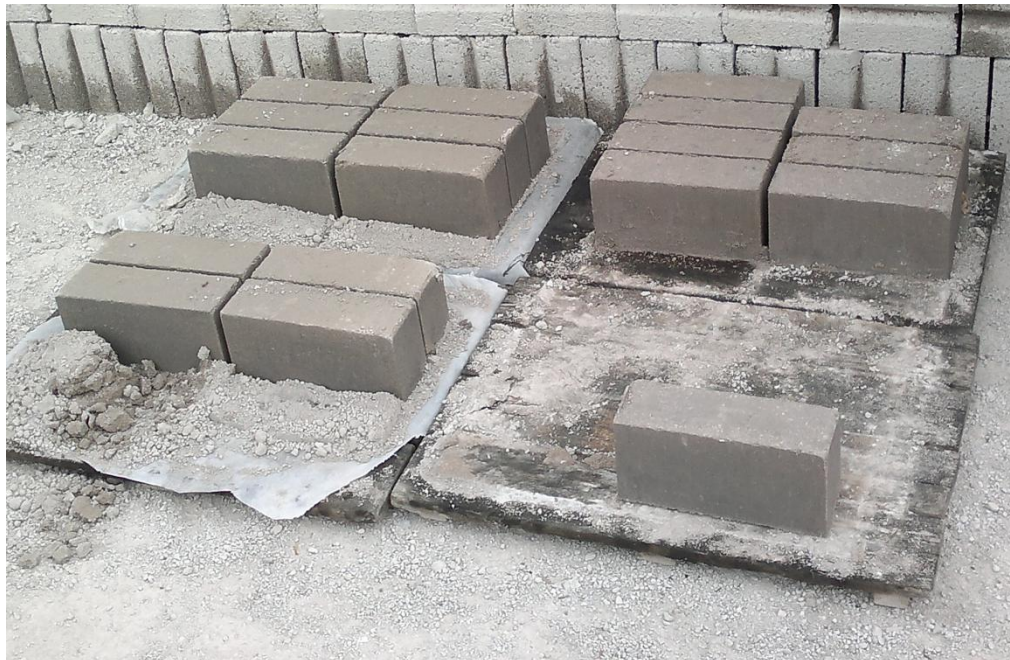
Figura 4.15 Colocación de lo tabicones tepetate-cal-ceniza volante sobre tarimas
