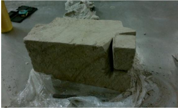
Figura 4.8 Labrado de las probetas
