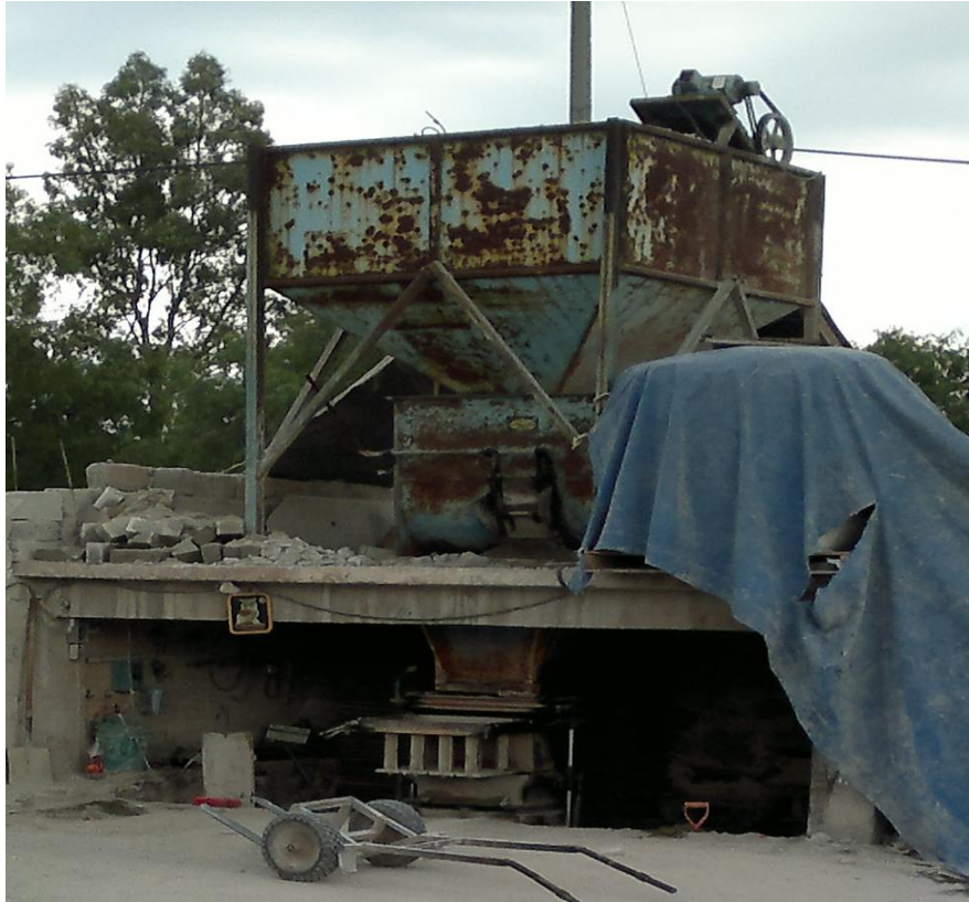
Figura 4.12 Bloquera utilizada para la elaboración de los tabicones de tepetate-cal-ceniza volante
