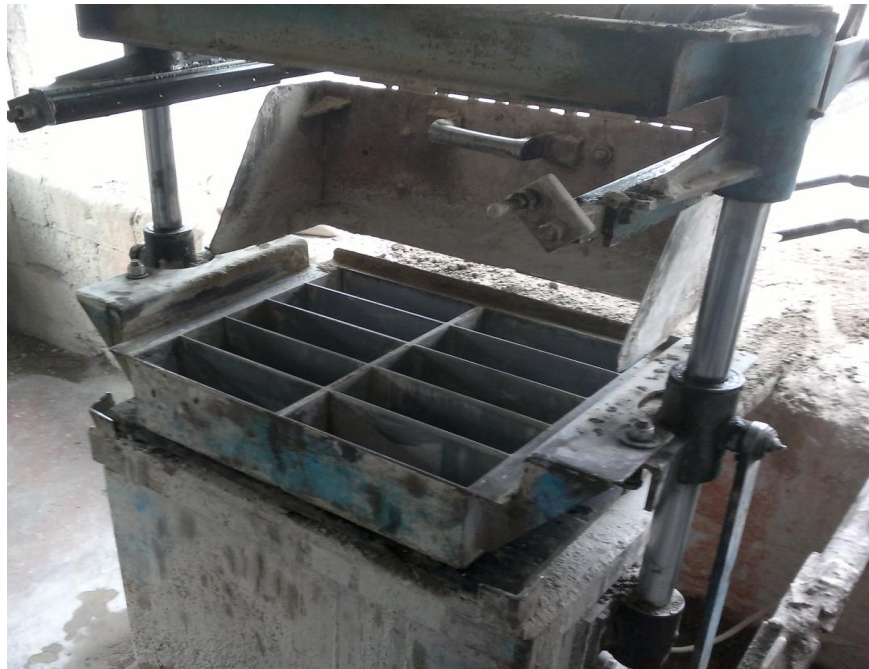
Figura 4.13 Moldes para la elaboración de los tabicones de tepetate-cal-ceniza volante
