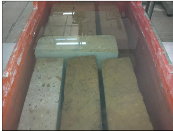
Figura 3.24 Especímenes en saturación por 24 horas en agua fría.
