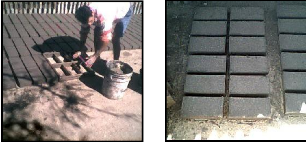
Figura 3.18 Fabricación artesanal de tabique de barro cocido (Ramírez, 2004).
