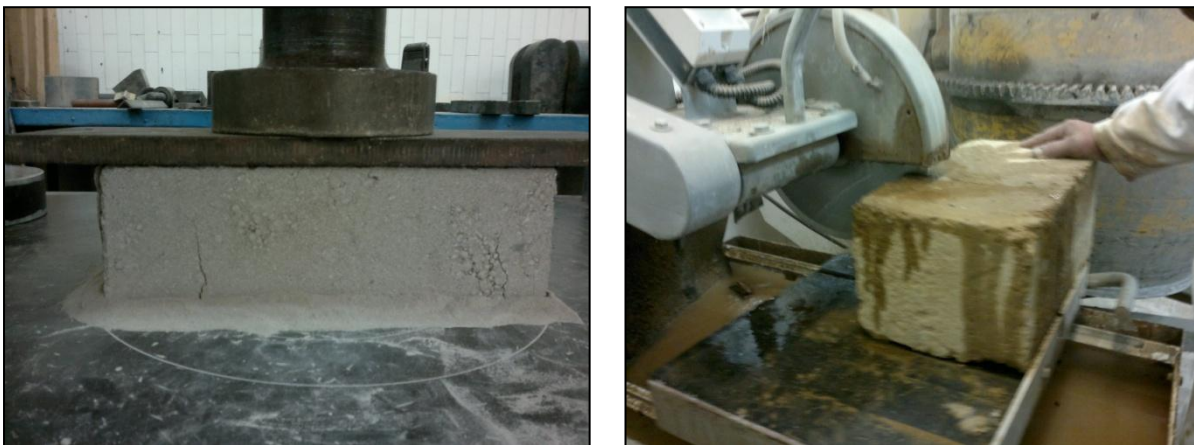
Figura 3.21 Ensaye a compresión de tabicones. Figura 3.22 Corte de sillares a tamaño de tabicón
