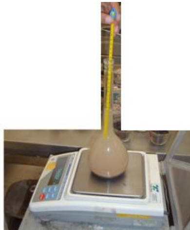
Figura 3.9 Peso de matraz con suelo y agua W_{fsw} .
