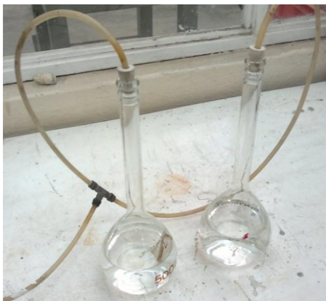
Figura 3.7 Matraces de vidrio de 500 ml. al vacío para obtención de la densidad de sólidos
