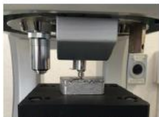
Figura 3. Prueba de microdureza de Vickers en lingote rebanado de aluminio reciclado con latas.
