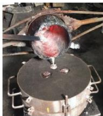
Figura 4. Vertido de aluminio fundido en estado líquido con NTC en molde de arena.
