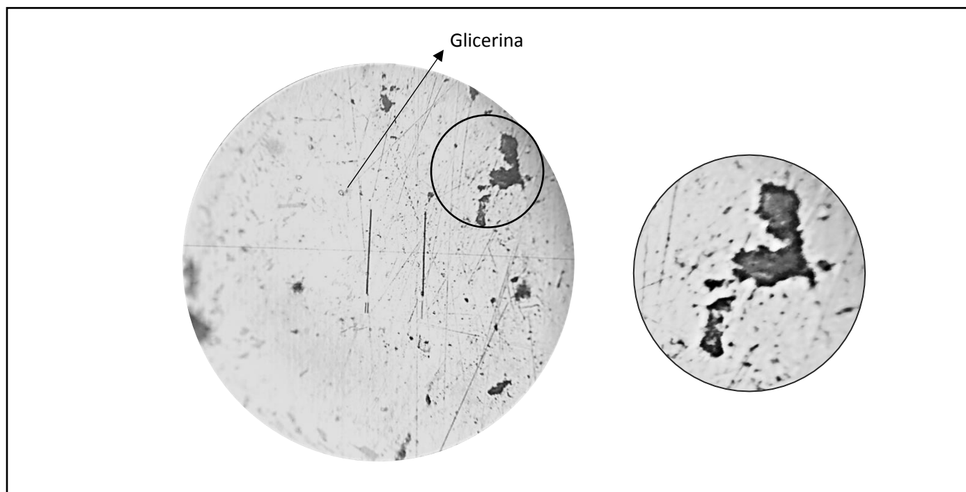
Figura 26. Imagen por microscopio de matriz de aluminio con aglomeraciones de nanotubos de carbono.
