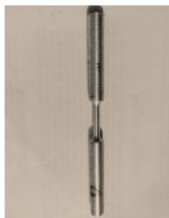
Figura 5. Ejemplo de probeta para prueba de tensión torneada a partir de fundición.
